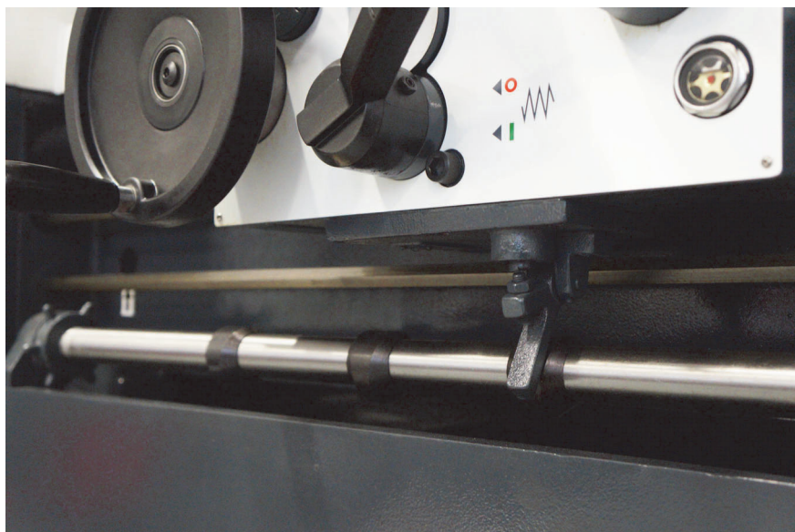
Obr.5-7: Mechanický koncový vypínač podélného posuvu
