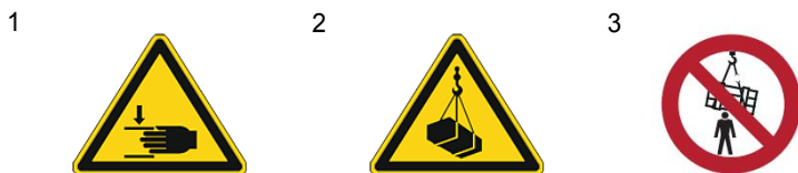
Obr. 1-1: Výstražné štítky (1 Nebezpečí přímáčknutí / 2 Varování před houpajícím se nákladem / 3 Zákaz pohybu pod nákladem)
