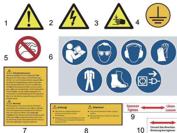
Obř. 1: Výstražné štítky - 1 Varování před nebezpečím | 2 Varování před nebezpečným elektrickým napětím | 3 Nebezpečí skřípnutí horních končetin | 4 Uzemnění | 5 Nedotýkejte se! | 6 - 8 Bezpečnostní pokyny | 9, 10 Směr otáčení
