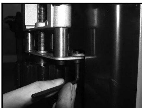
Obr. 11: Připevnění frézovacího stolu k pracovnímu stolu stroje
