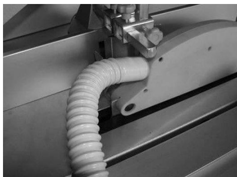
Obr. 21: Montáž odsávací hadice
