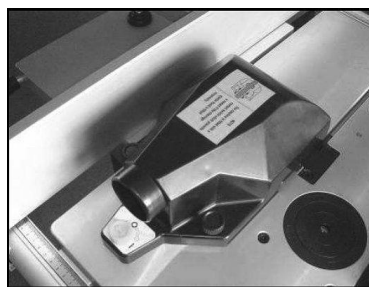
Obr. 36: Montáž odsávacího zařízení
