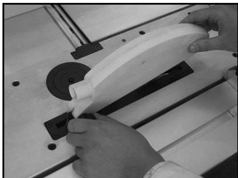
Obr. 19: Montáž krytu pilového kotouče
