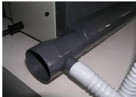
Obr. 22: Montáž odsávací hadice na odsávací trubku
