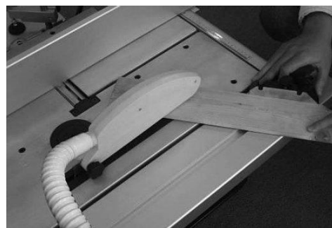
Obr. 24: Úhlový řez pomocí úhlového dorazu
