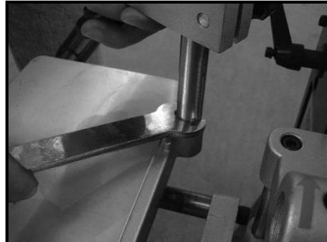
Obr. 12: Montáž upínacího zařízení obrobku
