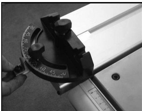
Obr. 9: Montáž úhlového dorazu
