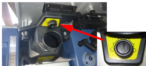
Obr. 17: Montáž odsávacího zařízení
