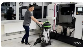
Vysavač flexCAT 378 EOT-PRO pro vysávání emulzí a třísek
