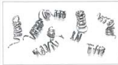
Volně navíjené třísky – správné řezné podmínky
