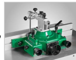
► Frézovací doraz s jemně nastavitelnými hliníkovými dorazy
