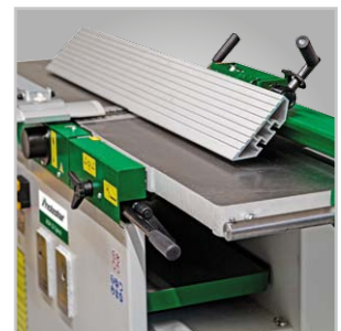
▶ Nastavení úběru třísky pomocí páky
