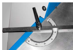
Nastavitelný úhlový doraz s milimetrovou stupnicí
