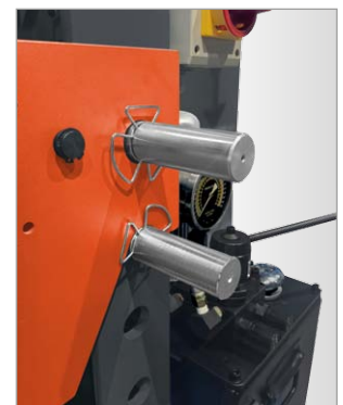
▶ Důkladná fixace pomocí dvou ocelových tyčí na každé straně lisovacího stolu
