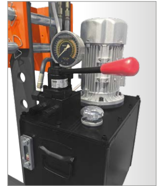
▶ Ovládání hydrauliky lisu
