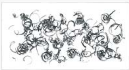
Tenké třísky nebo třísky tvořící prach – zvýšte posuv
