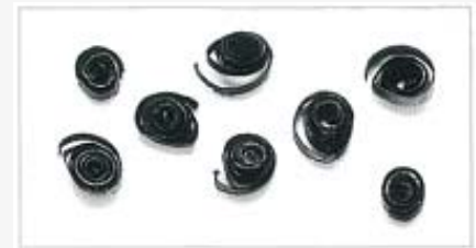
Tlusté, těžké nebo modré třísky – příliš vysoká rychlost řezání
