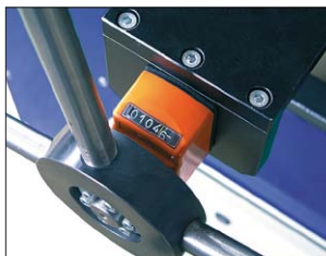
Všechny kladky je možné přesně polohovat pomocí mechanických počítadel.
