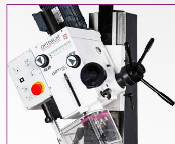
Naklápěcí frézovací hlava \pm 60^\circ .
