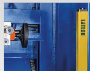
Optická čidla zabezpečují zadní prostor stroje.
