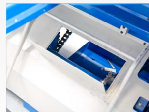
Volitelný oddělovač malých dílů a šuplík
