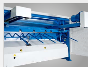
Pneumatický držák tenkých plechů (volitelné příslušenství)
