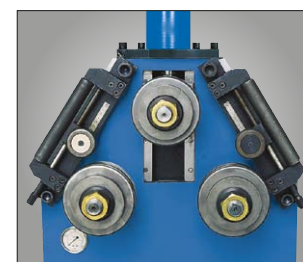
Speciální boční vodící kladky pro úhlové zakružování
