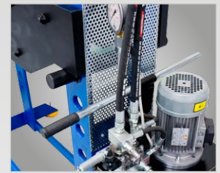
Ovládání hydrauliky lisu.
