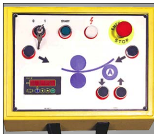
Digitální odměřování zadního válce (volitelné příslušenství)
