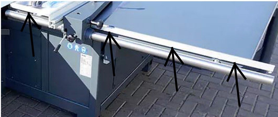
Obr. 5-5: Montáž dorazové lišty podélného dorazu
