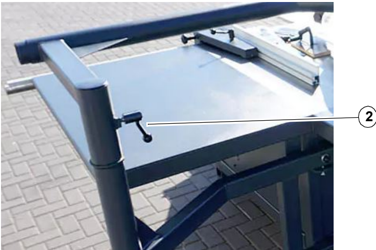
Obr. 5-8: Montáž ramene ochranného krytu
