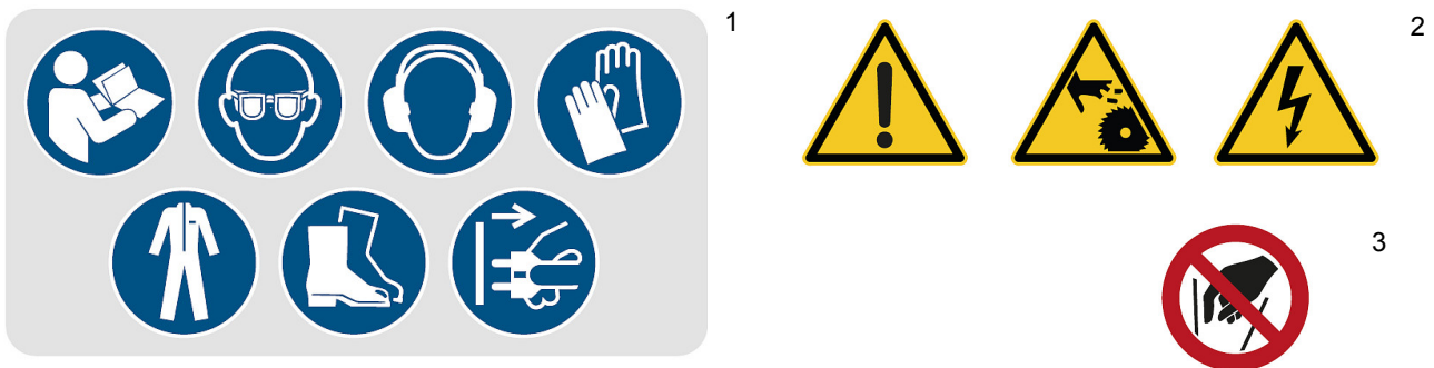
Obr. 1-3: Výstražné štítky - Postupujte podle pokynů v návodu, Použijte ochranné brýle, Použijte ochranná sluchátka, Použijte ochranné rukavice, Použijte pracovní oděv, Použijte pracovní obuv, Vytáhněte zástrčku z elektrické sítě I 2 Obecný zákaz, Nebezpečí poranění rukou, Otáčející se díly, Nebezpečné napětí I 3 Nedotýkejte se!
