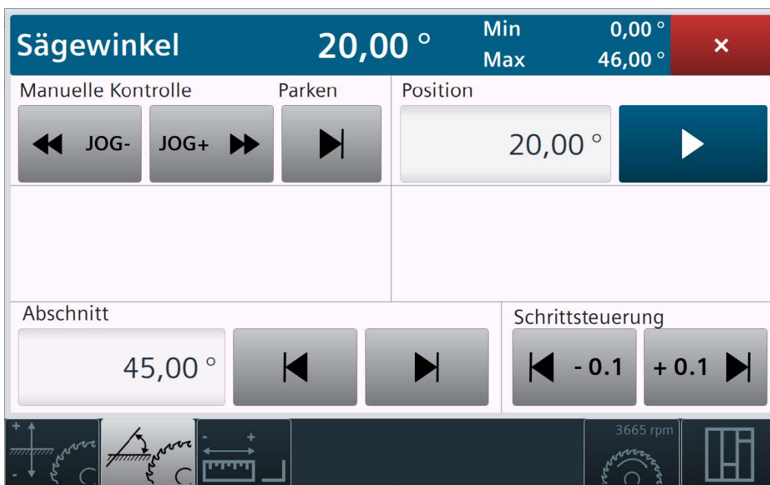
Obr. 7-10: Nastavení parametrů pilového kotouče
