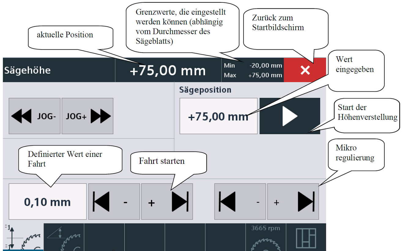
Obr. 6-9: Výškové nastavení kotouče FKS 550-3200 M A 3 UP TOP
