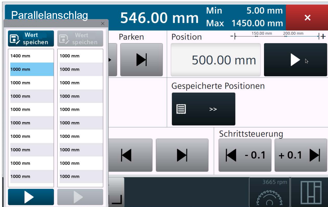
Obr. 7-11: Nastavení podélného pravítka
