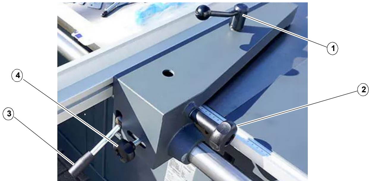
Obr. 6-11: Nastavení příčného dorazu FKS 550-2300 PRO
