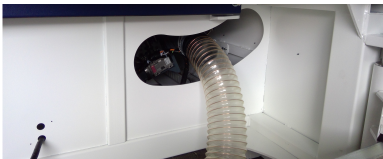
Obr. 5-15: Připojení odsávací hadice k formátovací pile
