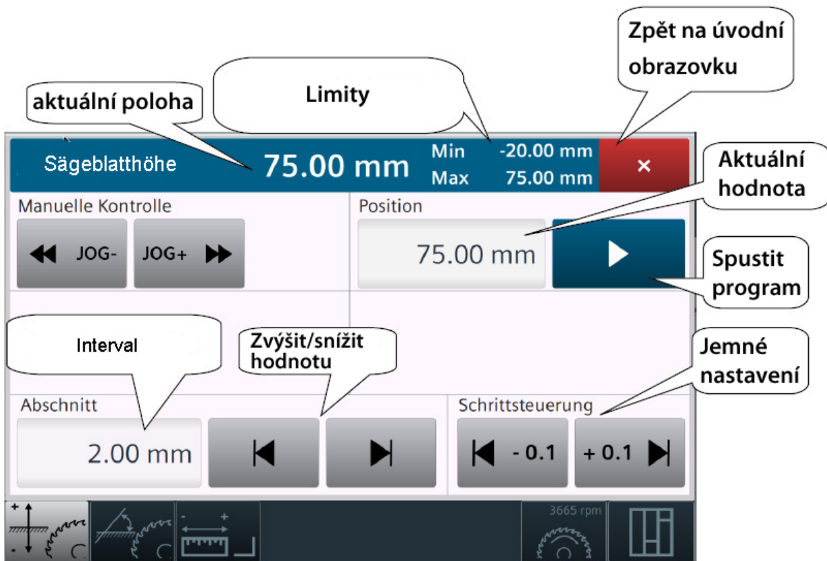
Obr. 7-9: Nastavení parametrů pilového kotouče
