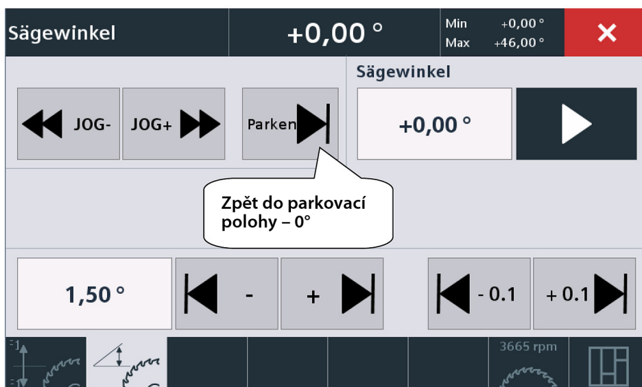
Obr. 6-10: Nastavení úhlu kotouče FKS 550-3200 M A 3 UP TOP
