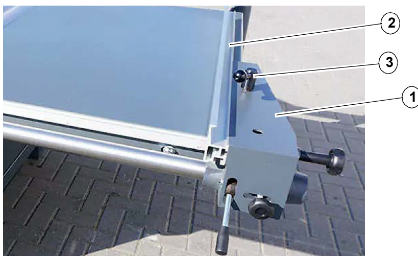
Obr. 5-7: Montáž podélného dorazu
