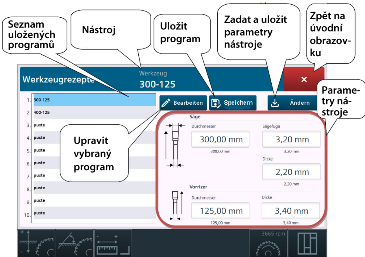
Obr. 7-8: Výběr nastavení stroje
