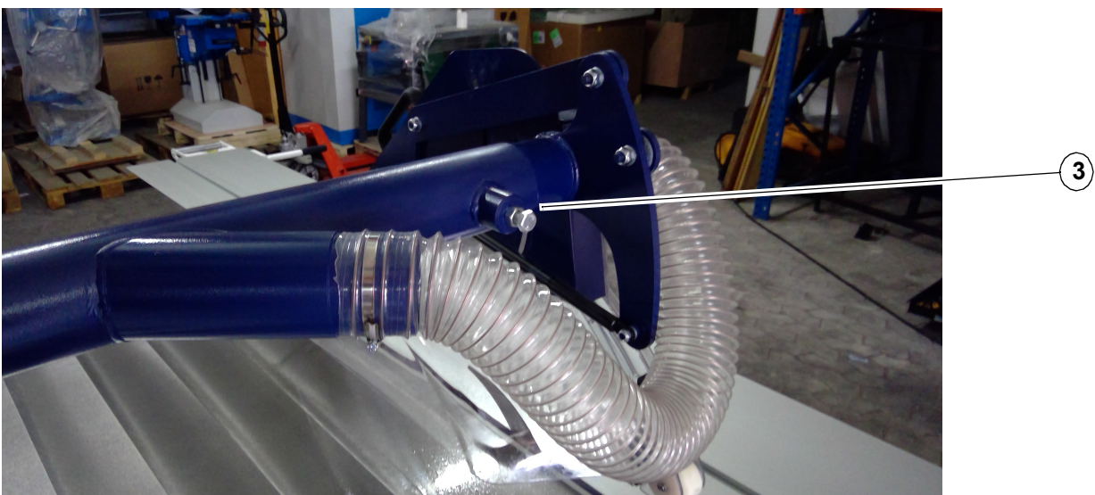
Obr. 5-9: Montáž ochranného krytu na rameno
