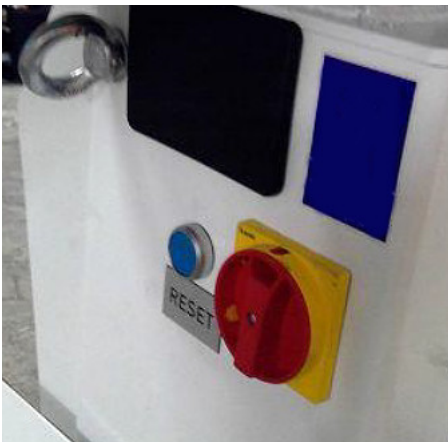
Obr. 8-1: Hlavní vypínač a tlačítko RESET, tlačítko ZAP/VYP na posuvném stole.
