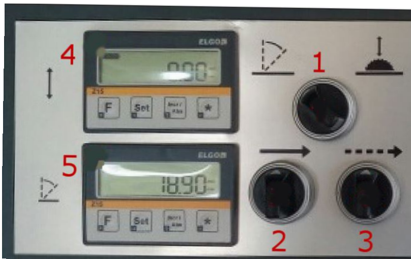
Obr. 6-7: Nastavení úhlu a výšky řezu FKS 550-3200 M A PRO
