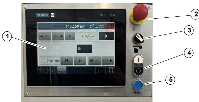
Obr. 4-6: Ovládací panel FKS 500-3200 M A 3 UP TOP
