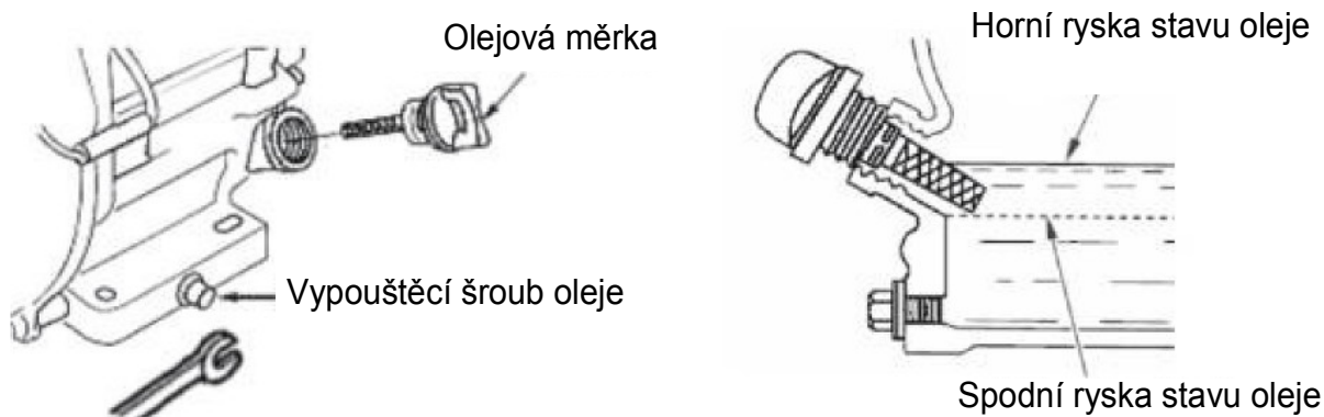
Obr. 7-1: Vypouštění oleje PG-I 35 SR
