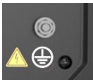
Obr. 4-16: Přípojka uzemnění PG-I 21 SR-S
