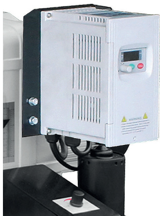
Obr. 12: Plynulá regulace rychlosti posuvu
