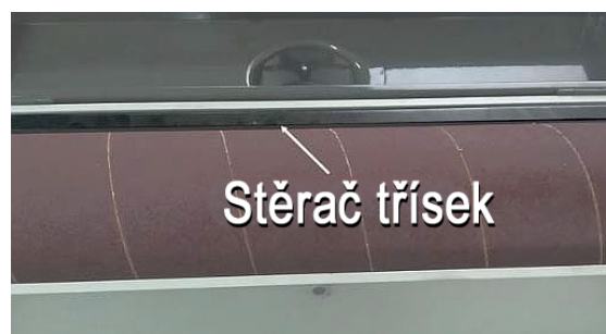
Obr. 32: Demontáž stěrače třísek
