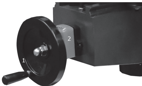
Obr. 5: Nastavení výšky vřeten ručním kolem
