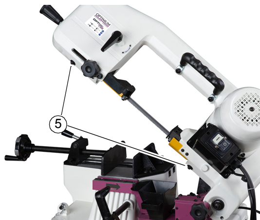
Obr.3-8: Montáž pilového pásu - 3
