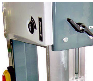
Obr. 8: Nastavení horního vedení pilového pásu
